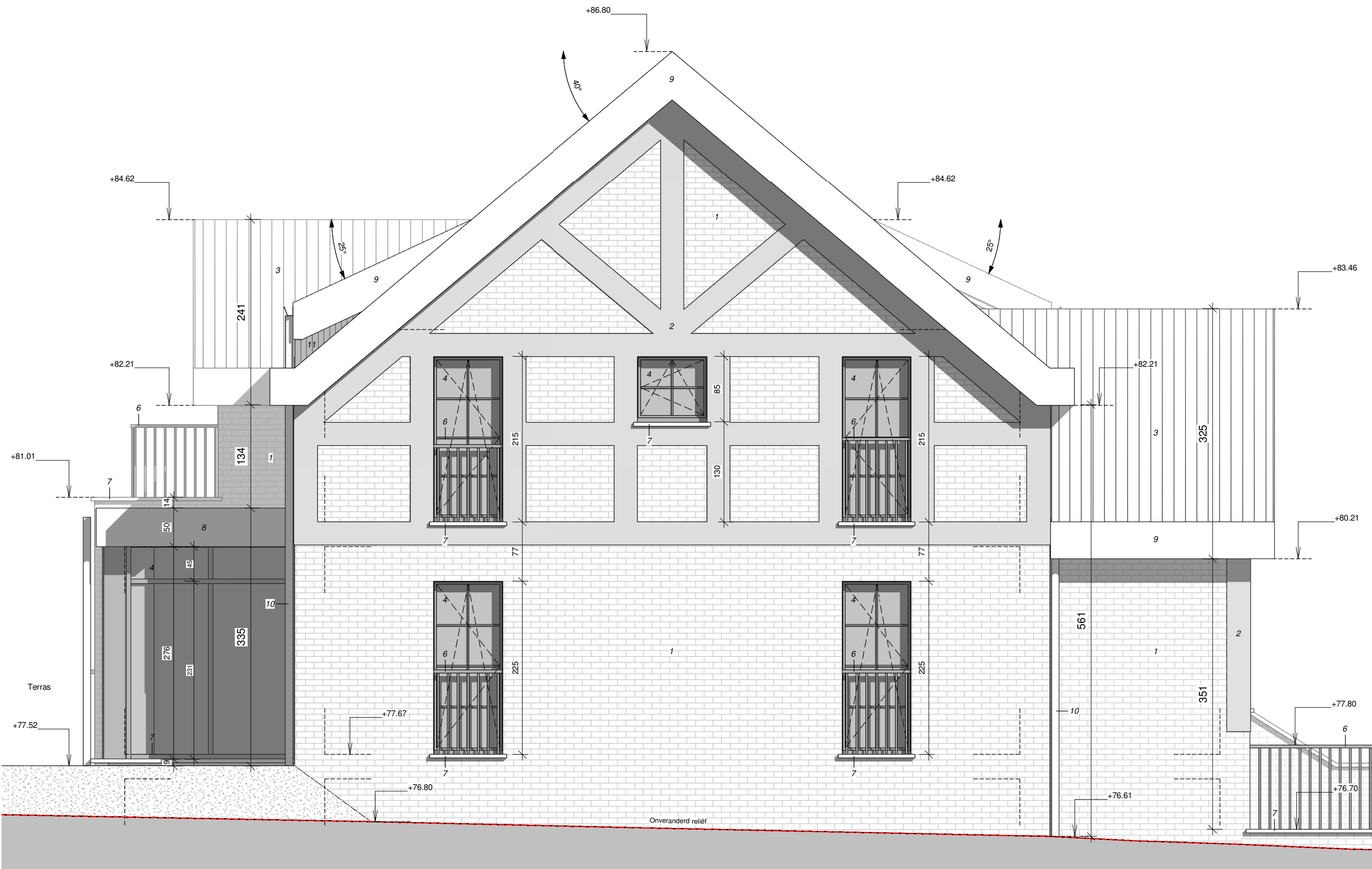
Élévation latérale gauche (est) - Echelle 1:50
